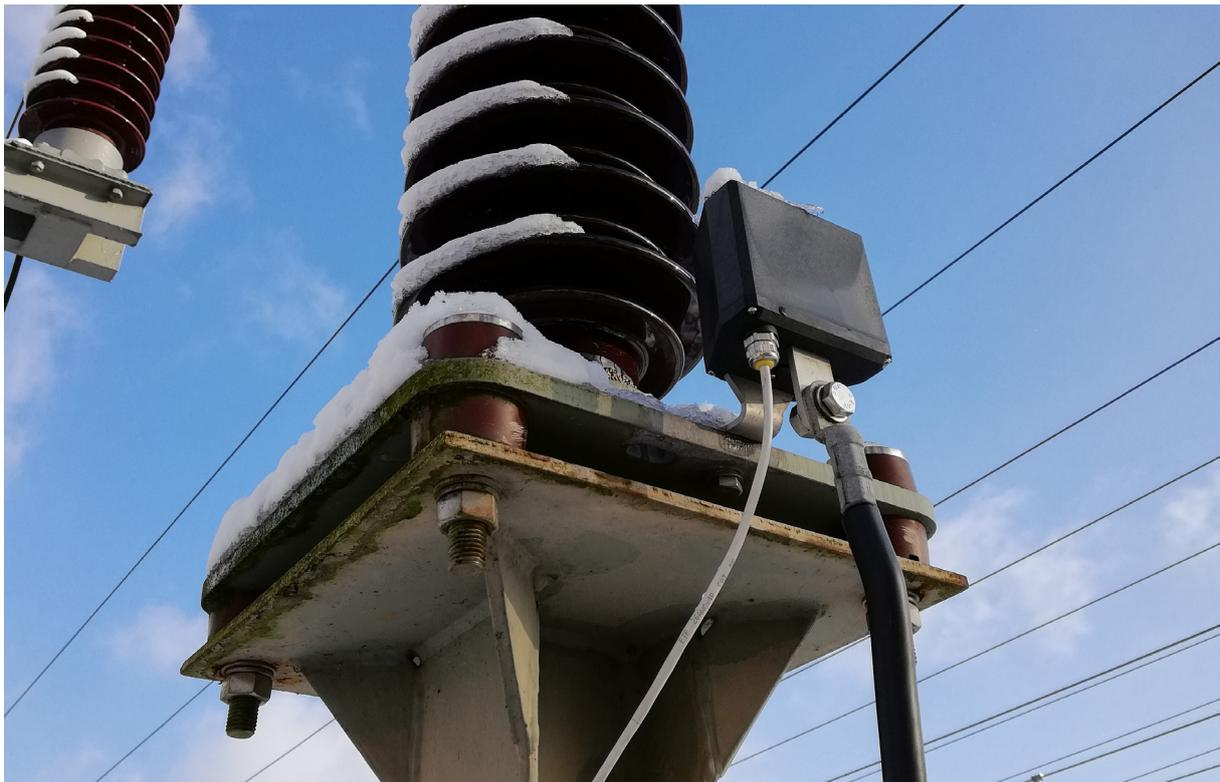
Figura 3.6.1 - **smartCOUNT** bajo prueba de campo
